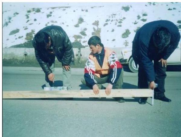
Рис.1.1. Натурные измерения для определения угла продольного или поперечного уклона дороги
