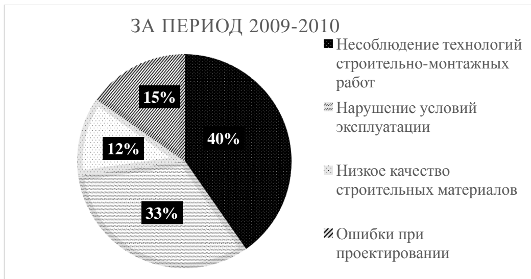
Рисунок 1. Причины обрушения зданий и сооружений по данным «ГЦЭ-Север» в период 2009-2010 года.
