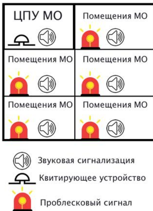
Рисунок 1. Схема аварийного оповещения машинного отделения
