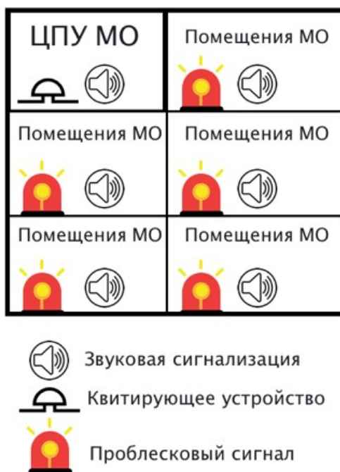
Рисунок 1. Схема аварийного оповещения машинного отделения
